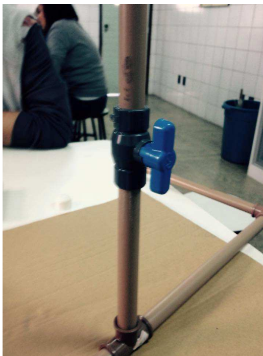
Imagem 7 – Construção da base de lançamento.
